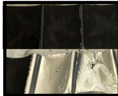
Nickel, Mangan und Kobalt Kathode – kurz NMC
